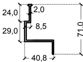
Z-Profil (Systemprofil am oberen Horizontalrand der Kassette)
