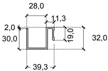
S-Profil (Systemprofil am unteren Horizontalrand der Kassette)
